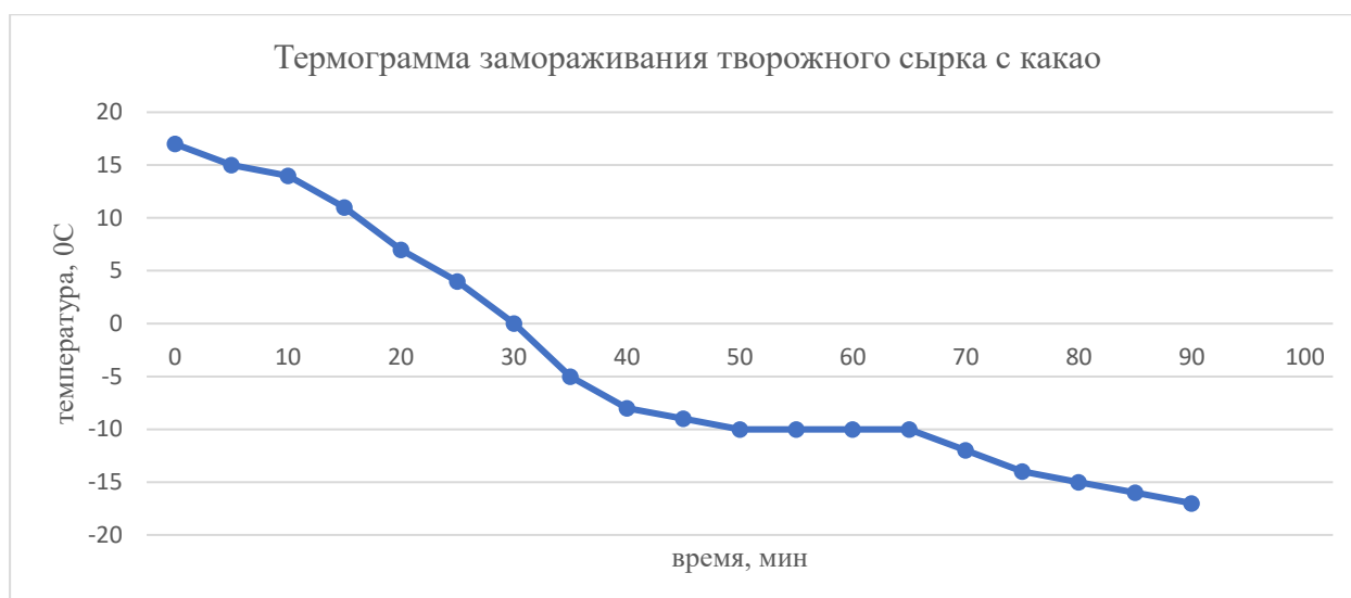
Рисунок 3. Термограмма замораживания сырка творожного с какао
